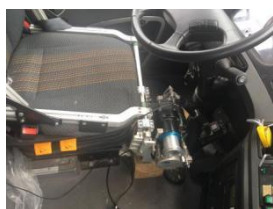
客车制动机器人安装
