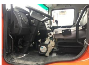
货车制动机器人安装
