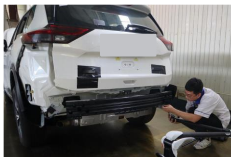
后防撞梁有效高度测量
