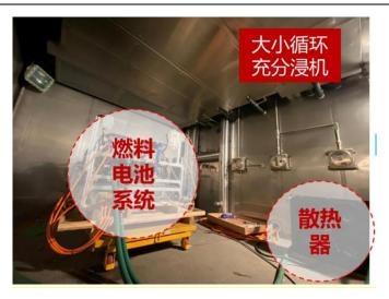
图 3.5 某品牌燃料电池发动机低温冷起动试验现场
